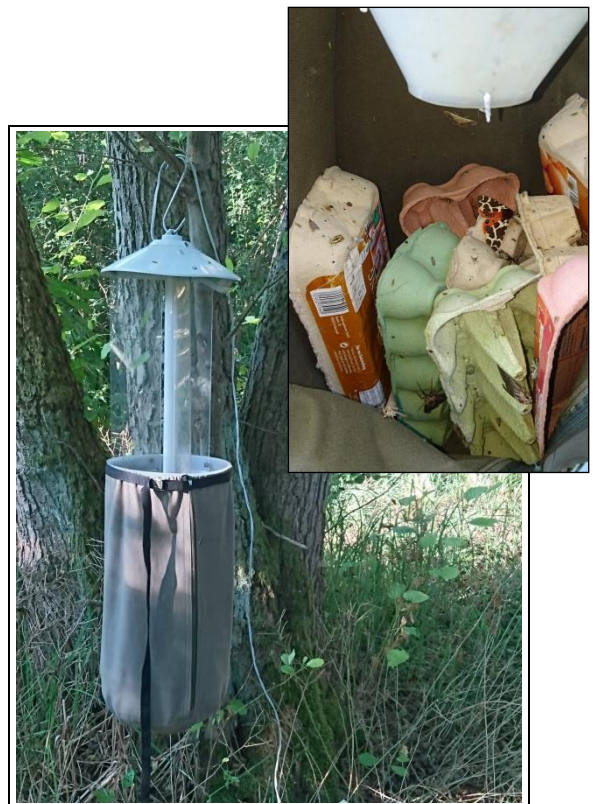
Abbildung 3: Batteriebetriebene Lichtfalle mit superaktinischer Leuchtröhre.
