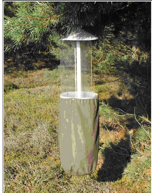
Abb. 4: Batteriebetriebene Lichtfalle mit superaktinischer Leuchtröhre.
