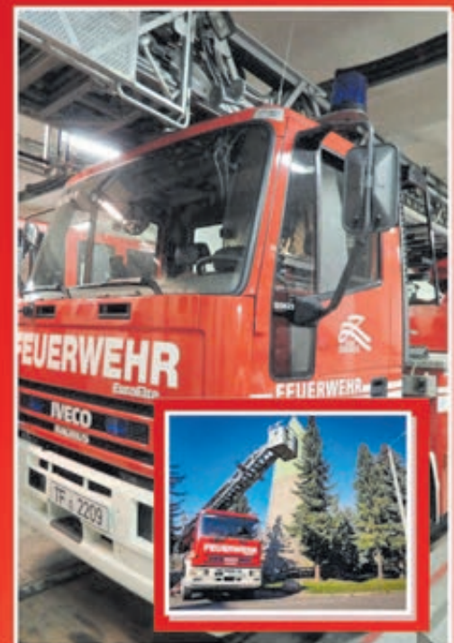
Die Drehleiter DL (K) 18/12 der Wünsdorfer Feuerwehr. Fotos: Feuerwehr Wünsdorf, Stadt Zossen
