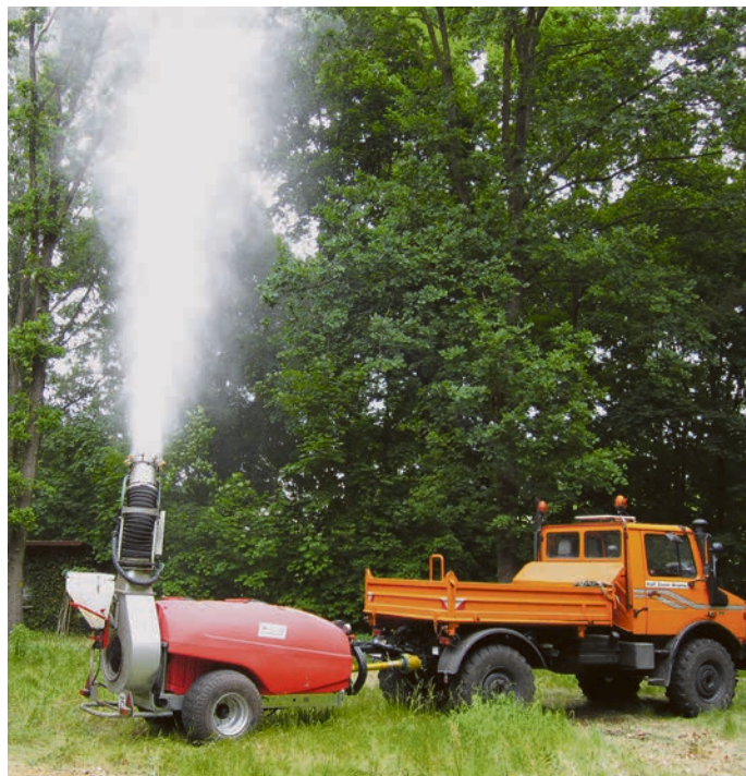
Turbinengebläsekanone zur Bekämpfung des Eichenprozessionsspinners. Foto: Stadt Zossen
